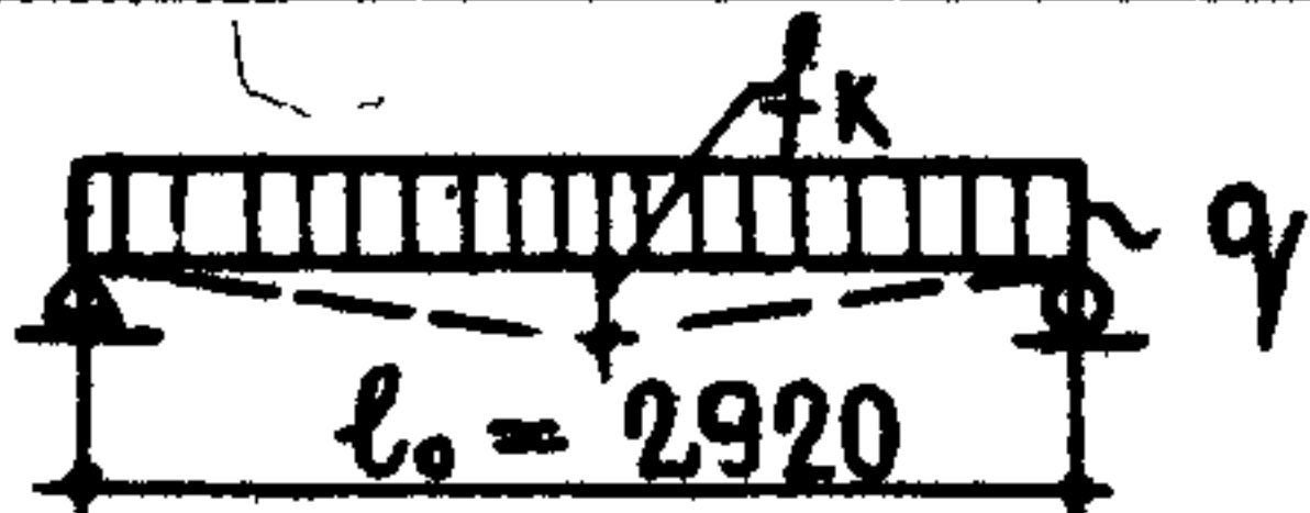
СХЕМА ОПИРАНИЯ И ЗАГРУЖЕНИЯ ПРИ ИСПЫТАНИИ (ПЛОЩАДЬ ЗАГРУЖ. 2.92x1.16М)
